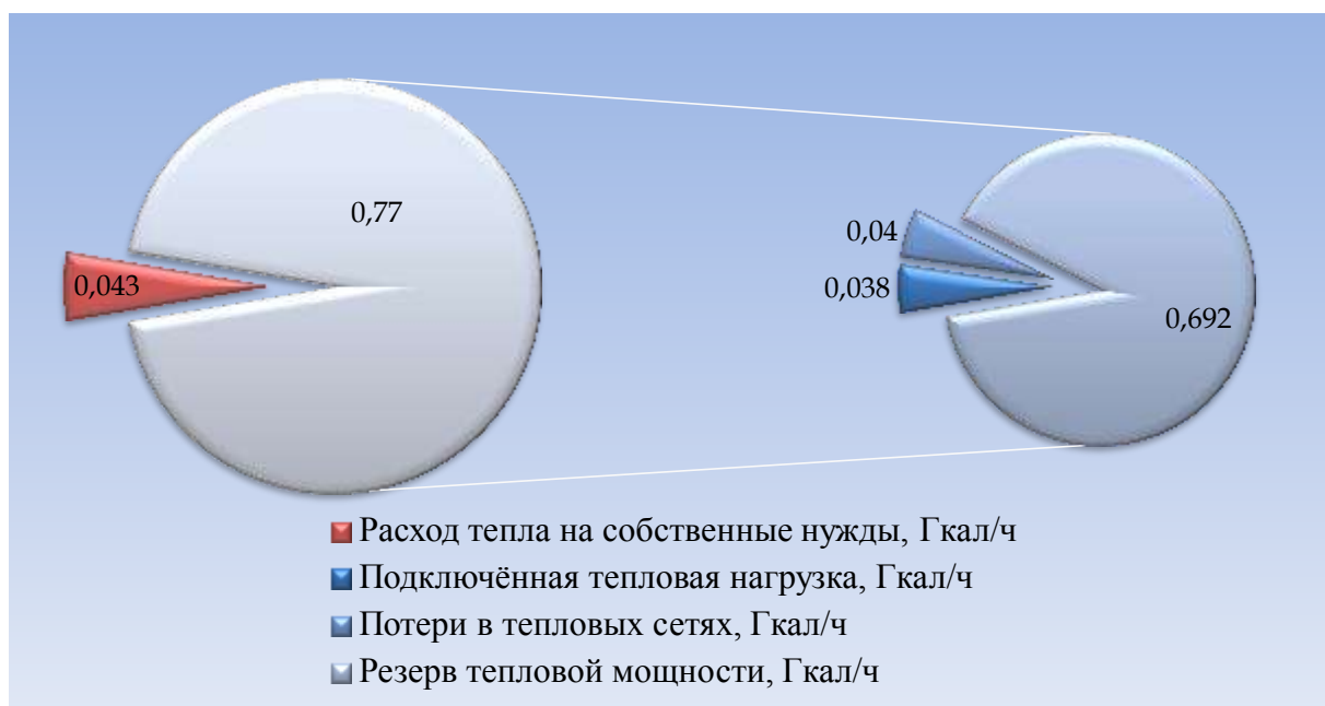
Рисунок 1.6.1.1 Тепловой баланс котельной №13
