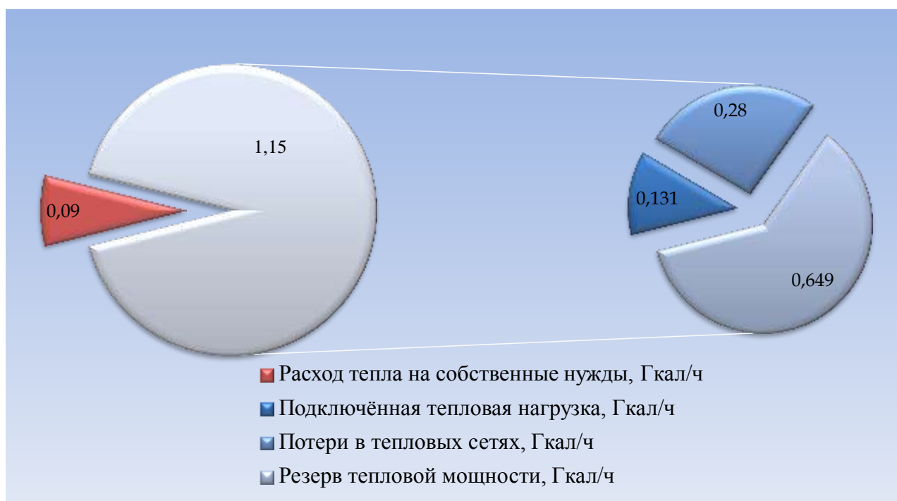
Рисунок 1.6.1.1 Тепловой баланс котельной №14
